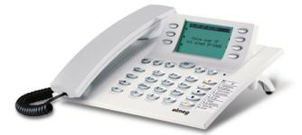
**Zwei Ethernet-Anschlüsse** erlauben den gemeinsamen Anschluss von Systemtelefon und PC über eine einzige LAN-Schnittstelle. Mit Power over Ethernet (PoE) kann das elmeg IP-S400 sogar über das LAN gespeist werden\* - damit wird das externe Steckernetzteil überflüssig.
